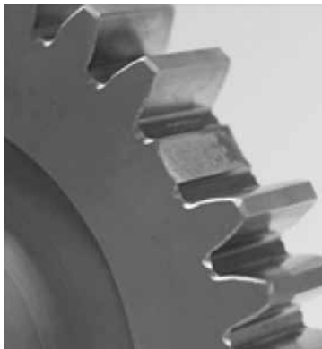
Fig. 5. Test gear with a broken tooth Rys. 5. Koło testowe ze złamanym zębem
